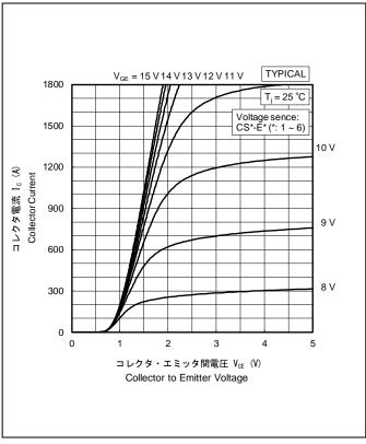
コレクタ電流ーコレクタ・エミッタ間電圧特性 (25 °C) Collector Current vs. Collector to Emitter Voltage (25 °C)
