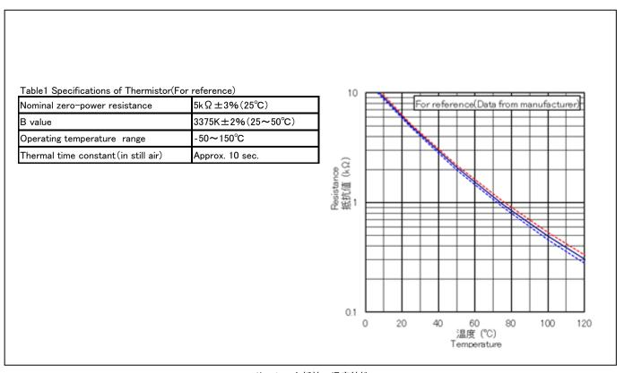
サーミスタ抵抗一温度特性 Thermistor Resistance-Temperature Characteristics
