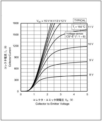
コレクタ電流ーコレクタ・エミッタ間電圧特性 (150 ℃) Collector Current vs. Collector to Emitter Voltage (150 ℃)
