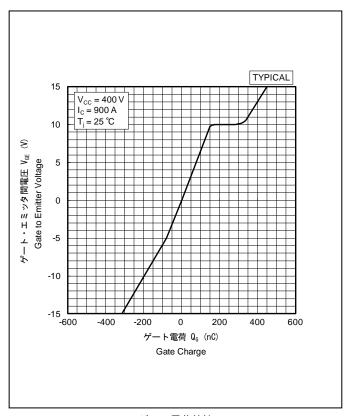
ゲート電荷特性 Gate Charge Characteristics
