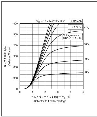
コレクタ電流ーコレクタ・エミッタ間電圧特性(175 ℃) Collector Current vs. Collector to Emitter Voltage (175 ℃)
